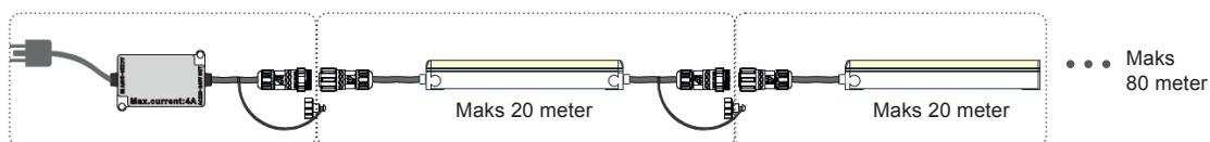
**230V LED Neon** er robust, UV-, løsemiddel-, saltvann- og flammeresistent og kan leveres i lengder på opptil 20 meter. Maks lengde pr tilkobling er 80 meter. IK08 Tilgjengelig i både F10, F11, F15 og F21 på forespørsel! IKKE DIMBAR!
