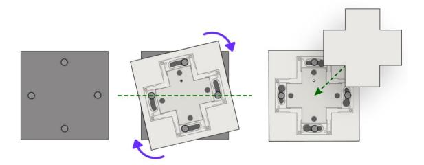
Abb.: 1.Montage anbringen 2. Schalter aufsetzen und drehen bis Schalter waagrecht ist 3. Kreuz einlegen
